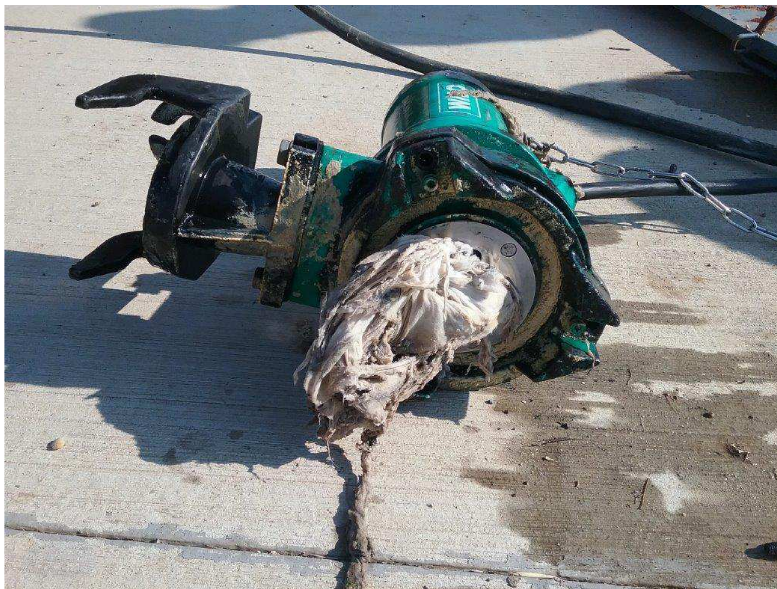
Upchané čerpadlo vlhčenými obrúskami
